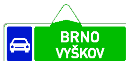
IS 2b Směrová tabule pro příjezd k silnici pro motorová vozidla (s dvěma cíli)
