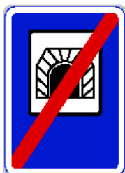
IP 8b Konec tunelu
